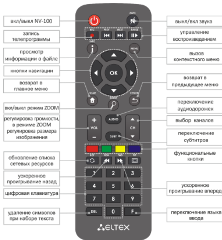
Рисунок 5 – Инфракрасный пульт дистанционного управления
