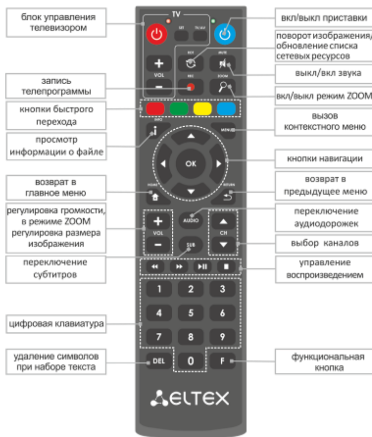
Рисунок 6 – Универсальный инфракрасный пульт дистанционного управления
