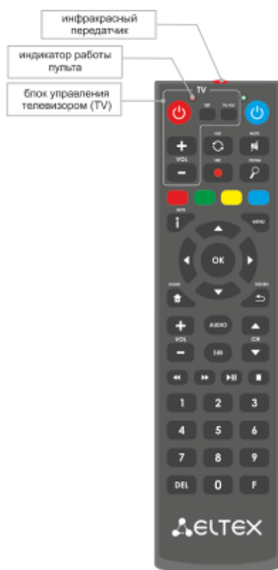
Рисунок 29 – Универсальный пульт дистанционного управления
